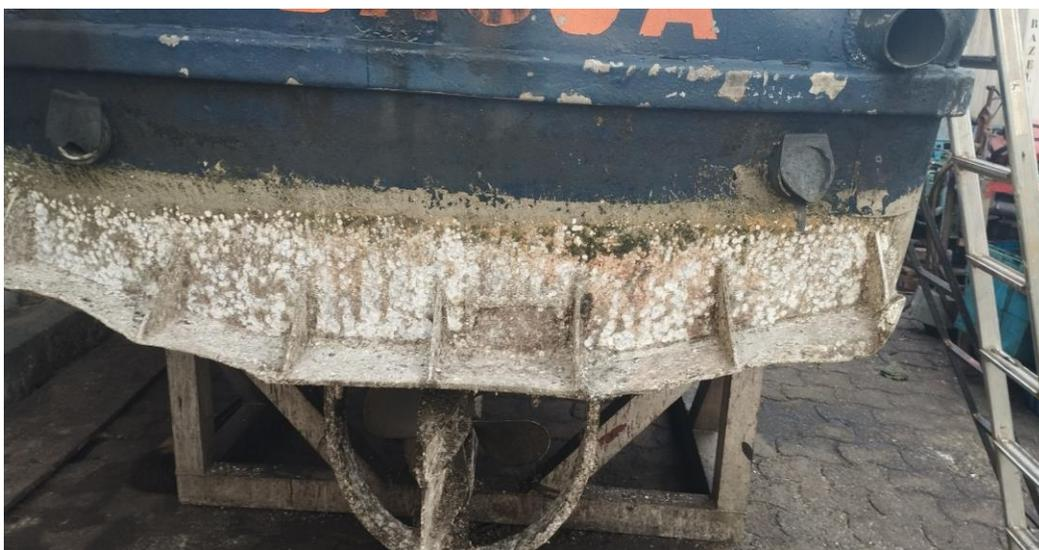
Fig.29 Coque en aluminium d'une vedette du lamanage corrodée
