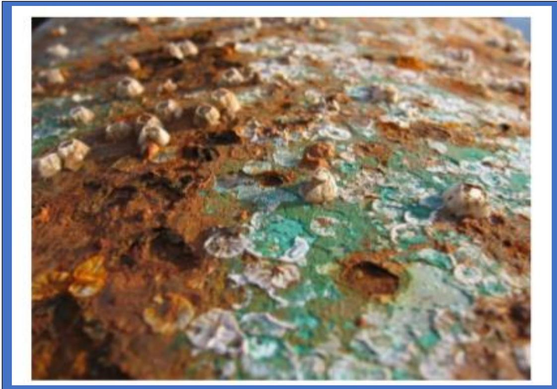
Fig.18 Exemple de métal ayant subi une forte corrosion en milieu marin oxygéné (avec de plus un phénomène de corrosion caverneuse sous les coquillages) [C]
