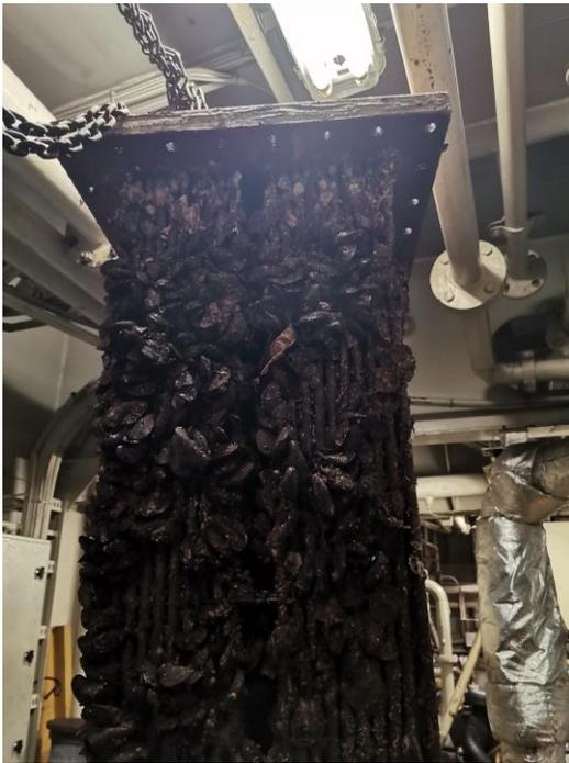
Fig.41 Faisceaux BOXCOOLER recouverts de coquillages
