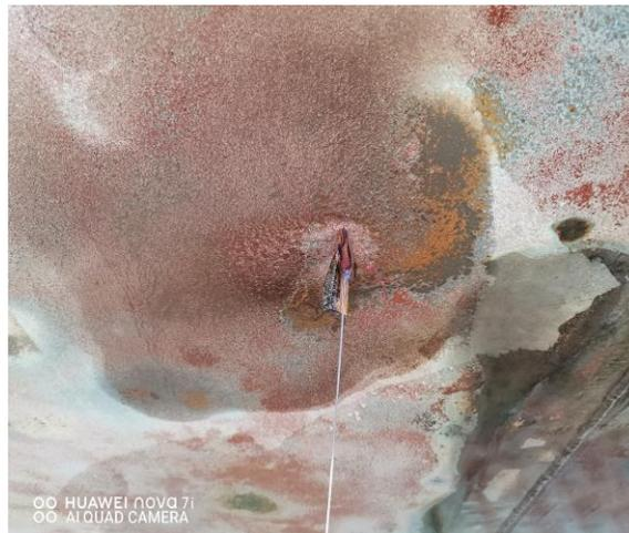
Fig.44 Perforation de la coque avec fuite de gasoil
