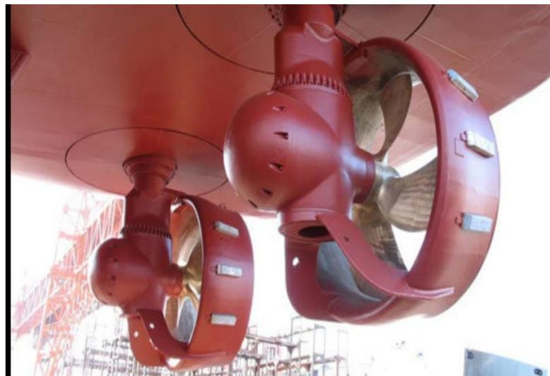
Fig. 36 PROPULSEUR ASD
