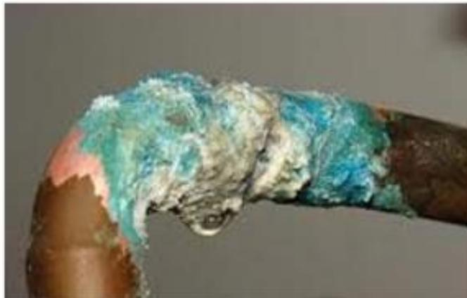
Fig.26 Produit de corrosion du cuivre
