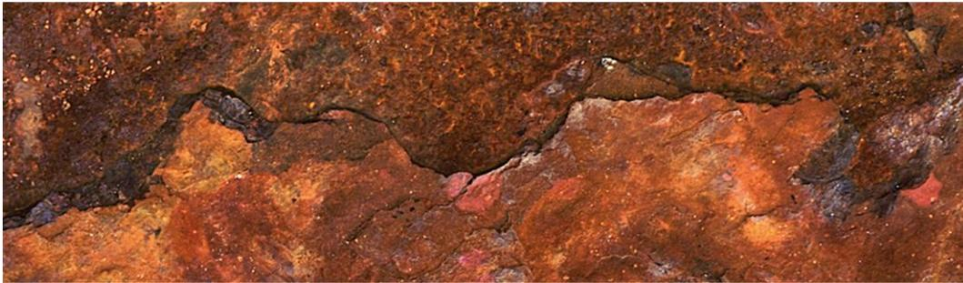
Fig.2 Corrosion sèche d'une structure métallique
