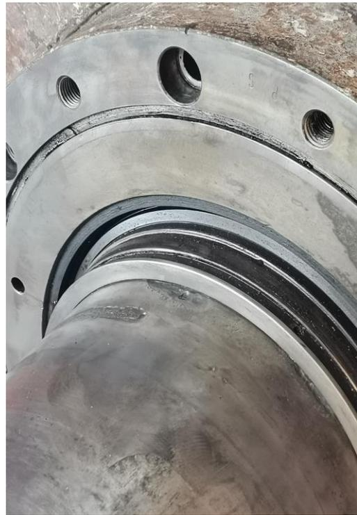
Fig.48 Cavitation sur arbre Intermédiaire de transmission latérale du propulseur
