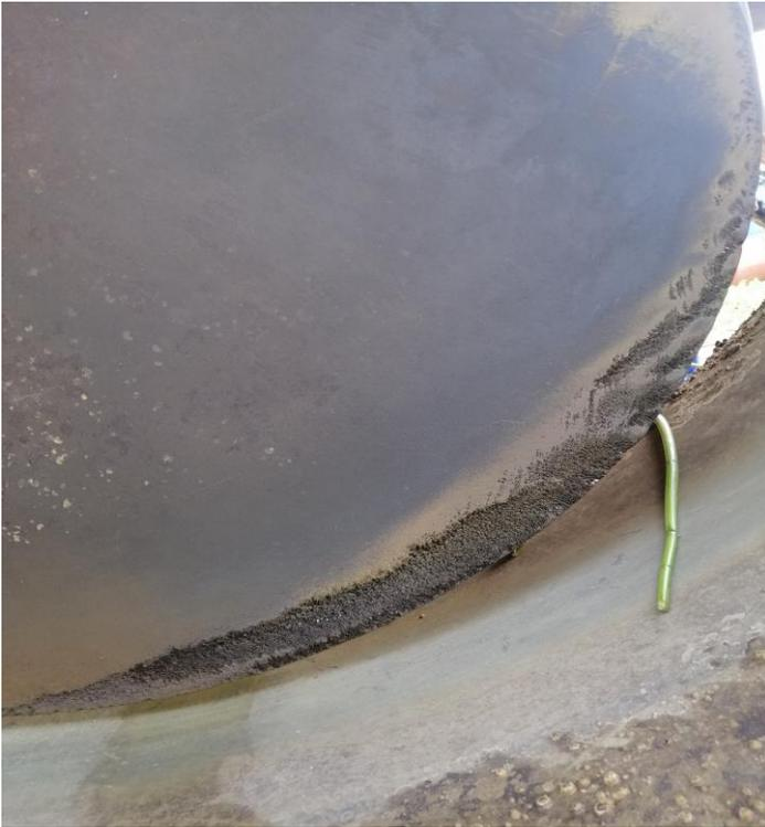
Fig.47 Cavitation au niveau des bordures des pâles de l'hélice
