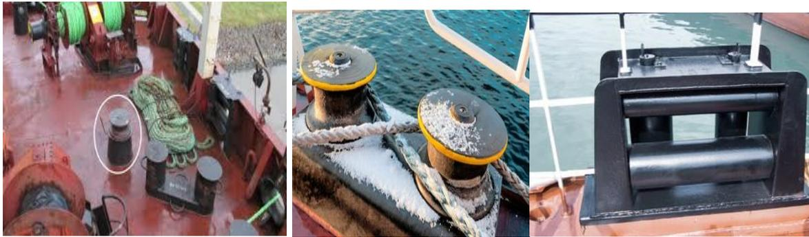
**FIGURE 8** : SCHEMA DE ROULEAUX ET GUIDE AMARRE A ROULEAUX
