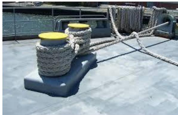
**FIGURE 7** : *SCHEMA DE BITTES SUR LE PONT D'UN NAVIRE*
